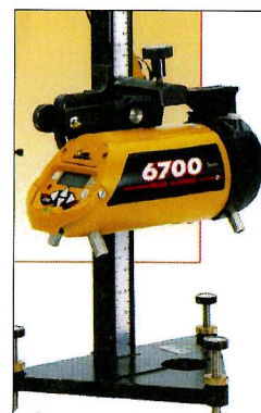
Figure 132. Beam Aligner 6700 utilisé pour la mise en place de bordures © DR
